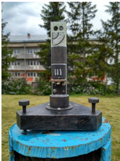
Рис.2. Приспосіблення для центрування відбивачів над центром трубчастого знаку
